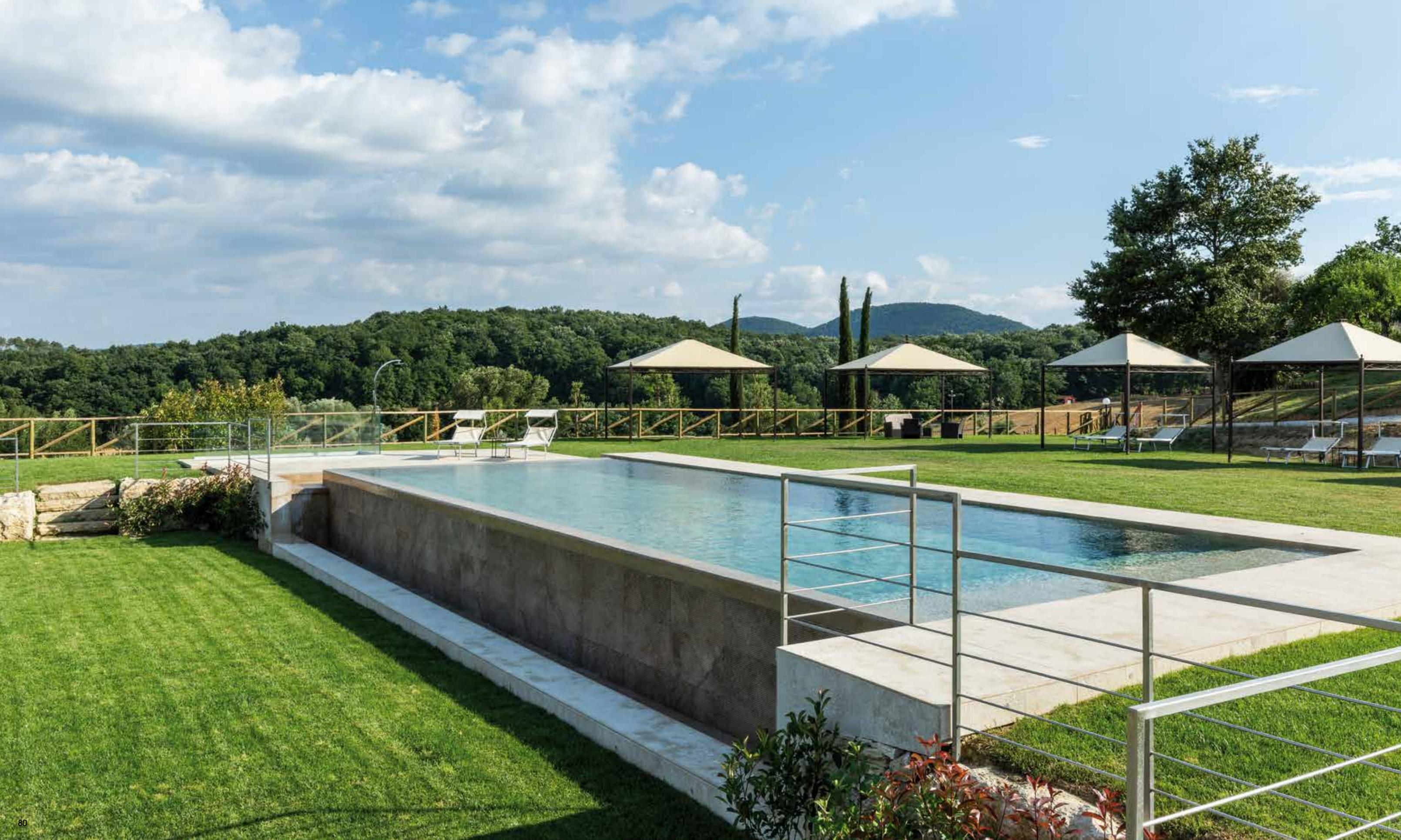
La piscina è rifinita con un pregevole travertino locale, levigato e spazzolato per l'interno, e con finitura sabbata per la fascia perimetrale esterna; la struttura in CLS è isolata con materiale in vetro cellulare per garantire un buon drenaggio e un ottimo isolamento termico.
